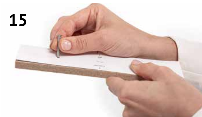
15 Markieren Sie die beiden Bohrpunkte (X), indem Sie eine Schraube fest durch das Papier drücken
