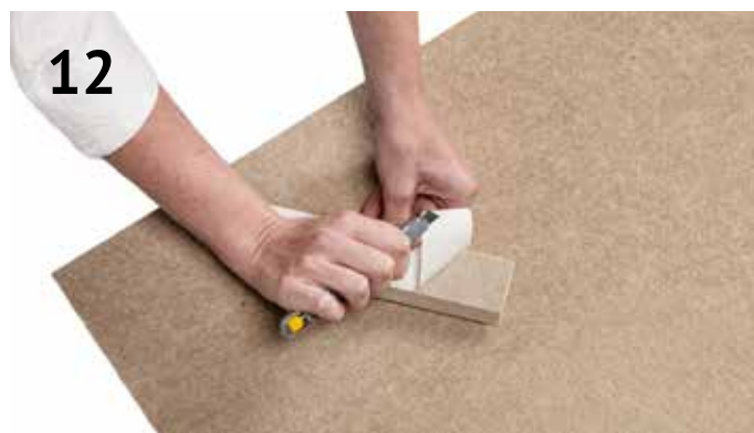
12 Rimuovere la pellicola protettiva dal nastro biadesivo
