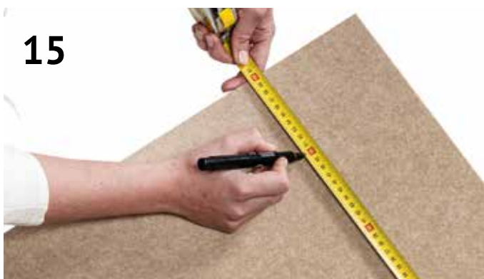
15 Segnare un punto a 10 cm dal bordo superiore sul lato destro
