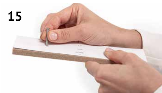
15 Markeer de twee boorpunten (X) door stevig een schroef door het papier te drukken
